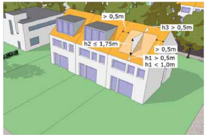
Een dakkapel die voldoet aan de in bovenstaand tekening gegeven afmetingen mag zonder omgevingsvergunning geplaatst worden
